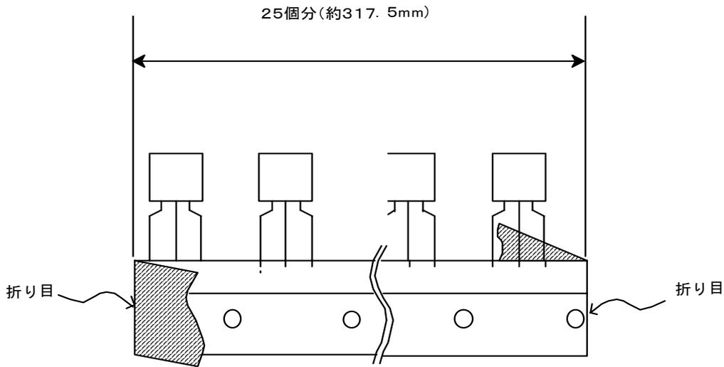
テーピング後、上図のようにつづら折りし、下図のように包装箱へ収納する。
