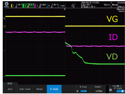
弊社製品INKE211AC1 リレー(SJ-1SG)耐久15個 V DSS =68V(テスト電特)
