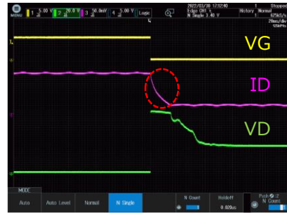
弊社製品INKE211AC1 リレー(SJ-1SG)耐久10個未満 V DSS =54V(テスト電特)
