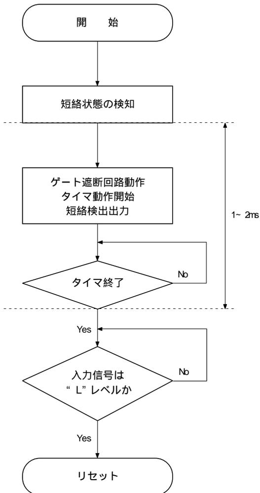
(注) 保護回路動作時の出力 “L” 電圧は、 $V_{EE} + \text{約 } 2V$ です。
