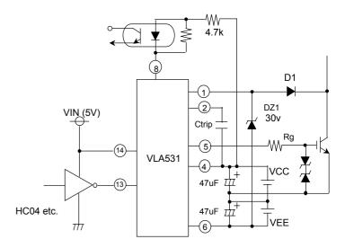
V<sub>CC</sub> = 15V V<sub>EE</sub> = 10V
