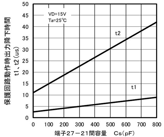
注意：保護回路動作時の出力“L”電圧は、V<sub>EE</sub>+約2Vです。
