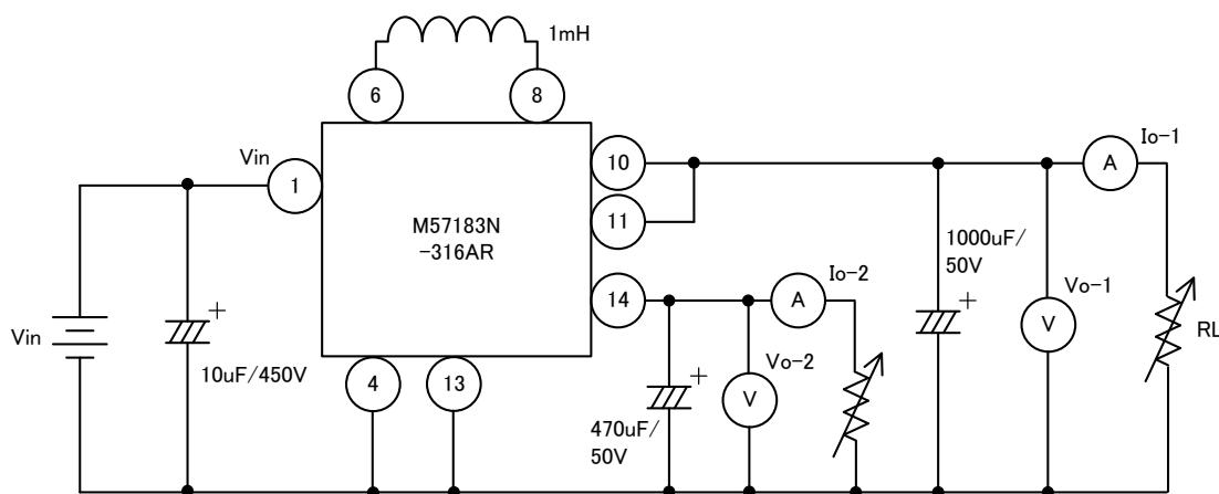
※出力側電解コンデンサは低インピーダンス品をご使用下さい。
