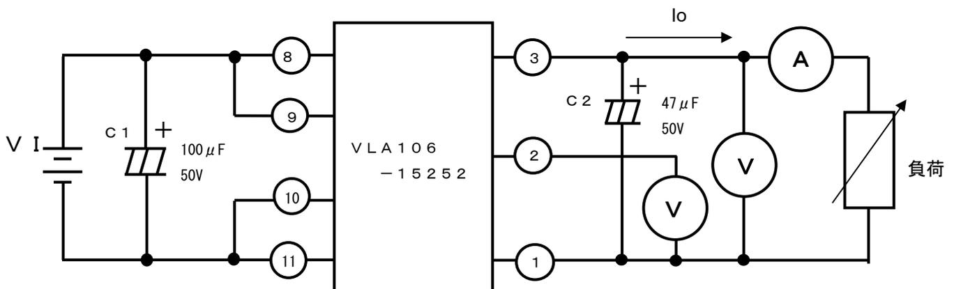
入出力電解コンデンサC1, C2は、低インピーダンス品使用。
