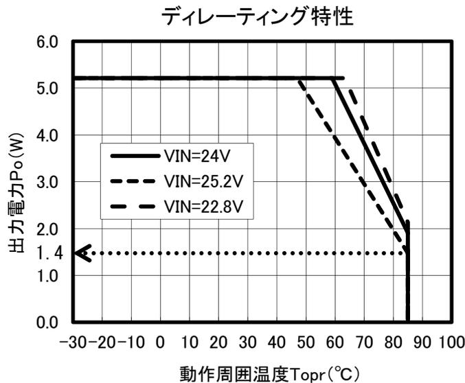
・電気的特性（指定のない場合は、 $T_a=25^{\circ}C$ 、 $V_{IN}=24V$ ）
