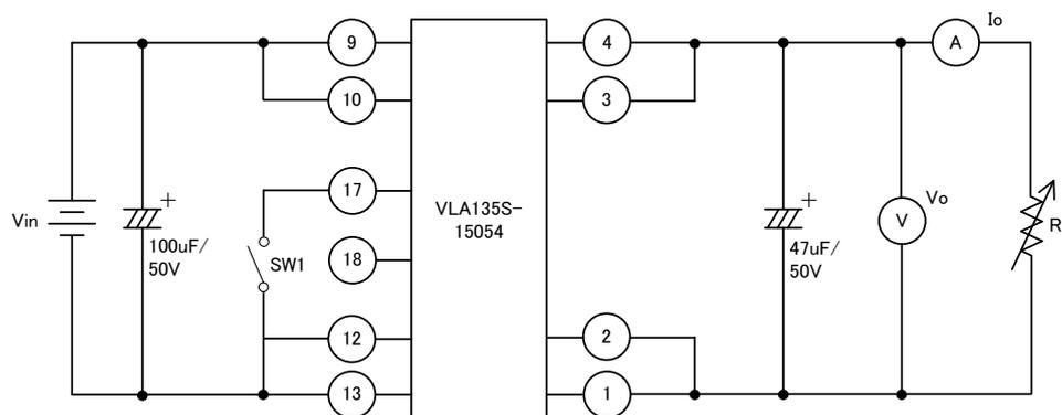
※入出力電解コンデンサは低インピーダンス品を使用ください。
