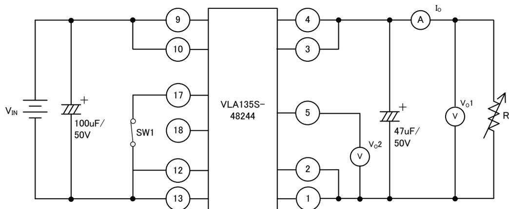
※入出力電解コンデンサは低インピーダンス品を使用ください。
