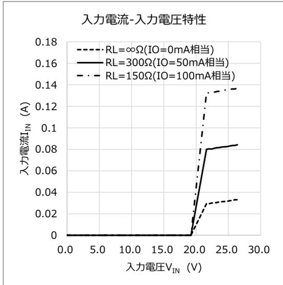
**特性曲線** (代表例、指定のない場合は、 $T_{opr}=25\text{ }^{\circ}\text{C}$ ,  $V_{IN}=24\text{V}$ )
