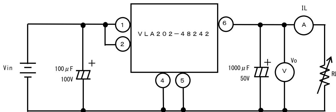
※出力側電解コンデンサは低インピーダンス品をご使用下さい。
