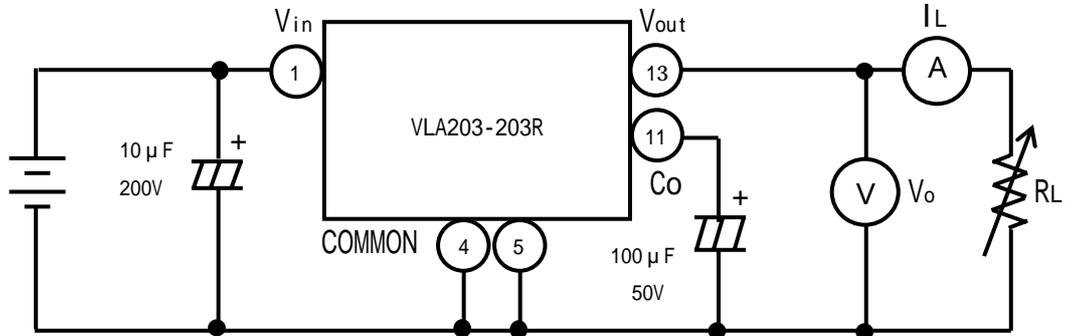
出力側電解コンデンサは、日本ケミコン製：KMFシリーズを使用。
