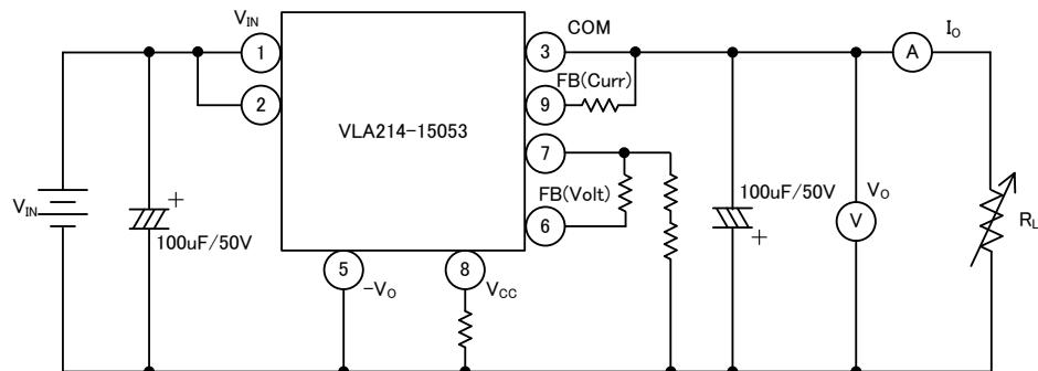
※出力側電解コンデンサは低インピーダンス品をご使用下さい。
