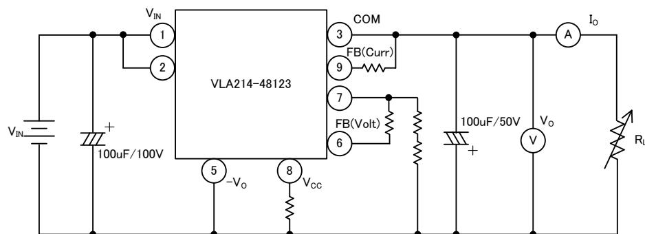
※出力側電解コンデンサは低インピーダンス品をご使用下さい。
