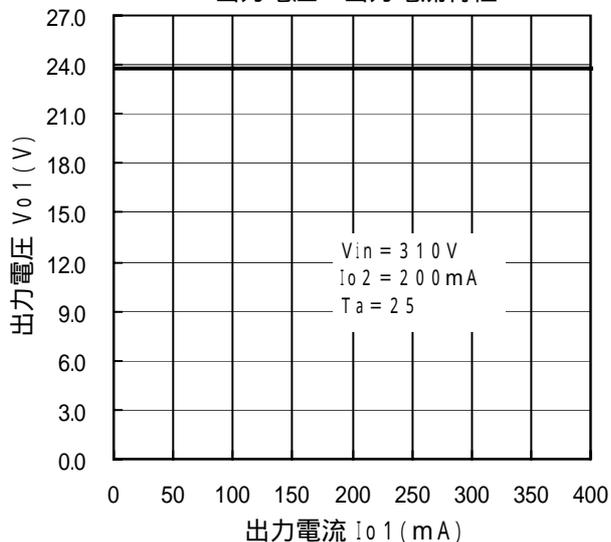
出力電圧 - 出力電流特性
