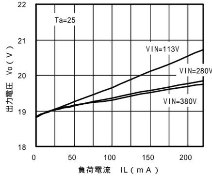
出力電圧 - 入力電圧特性 (代表例)
