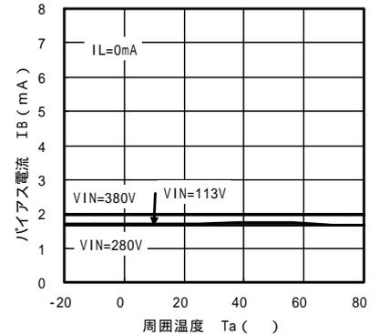
バイアス電流 - 入力電圧特性 (代表例)
