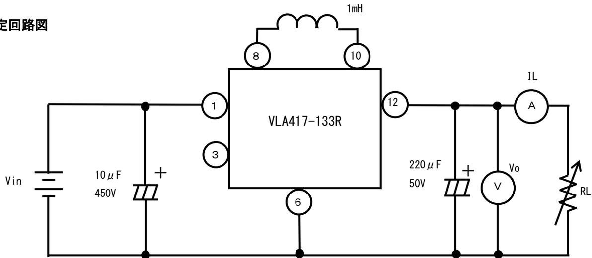
※出力側電解コンデンサは低インピーダンス品をご使用下さい。
