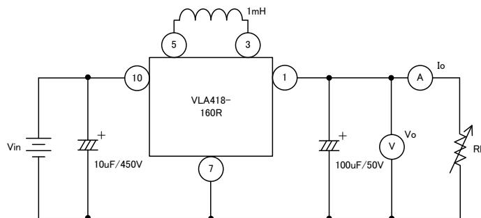
※出力側電解コンデンサは低インピーダンス品をご使用下さい。
