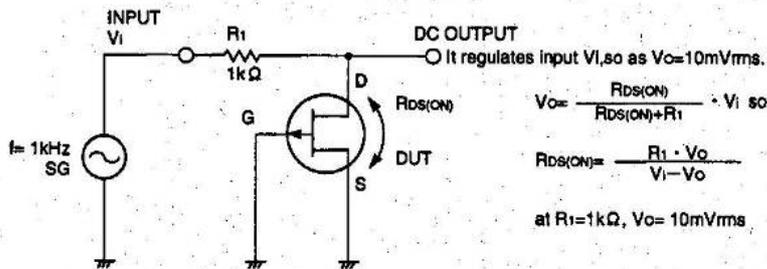
$$V_o = \frac{R_{DS(ON)}}{R_{DS(ON)} + R_1} \cdot V_i \text{ so}$$
