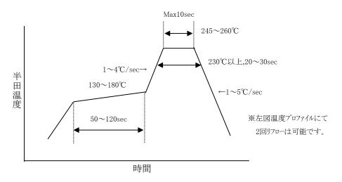
赤外線リフロー時の樹脂表面部の温度プロファイル(リフロー後、基板の強制冷却は避けてください。) 半田濡れ性を確保するため、ピーク温度245℃以上であることを推奨致します。
