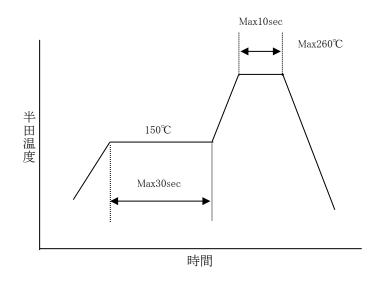
※リード品:リード部のみの浸漬とします。 ※左図温度プロファイルにて 2回フローは可能です。
