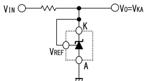
(2)  $V_{KA} > V_{REF}$
